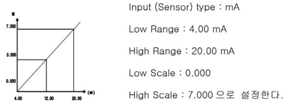
\*Analog 출력 사용시 Display Range의 최소값, 최대값을 변경하면 출력 Range의 최소값, 최대값도 같은 값으로 변경됩니다.
